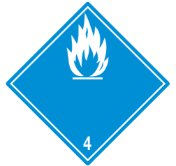
matières inflammables au contact de l'eau no symb. 403
